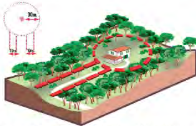
Imagen: Franja de seguridad anclada a un camino de acceso y área de baja carga de combustible alrededor de una vivienda. Fuente: Consejería de Medio Ambiente y Territorio.
